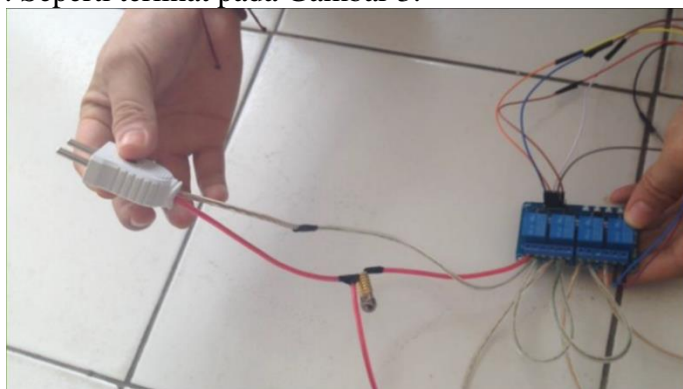
Gambar 3. Perakitan Lampu Pijar E10 pada Modul Relay
