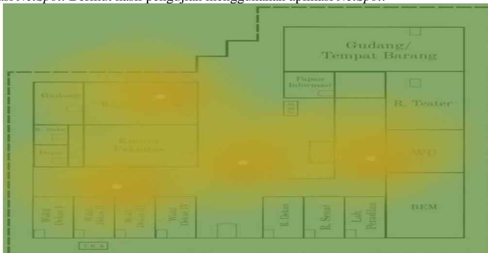
Gambar 4. Simulasi Penempatan 4 AP pada Lantai 2 Fakultas Agama
