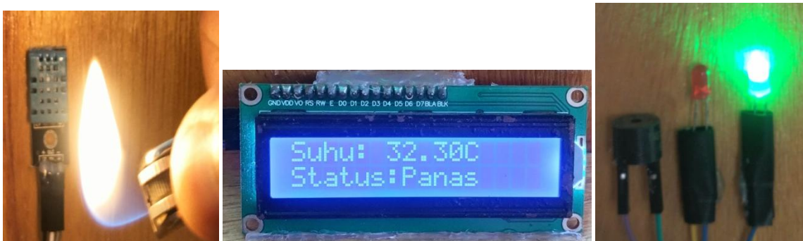
Gambar 7. Hasil Pengujian Sensor DHT11 Suhu
