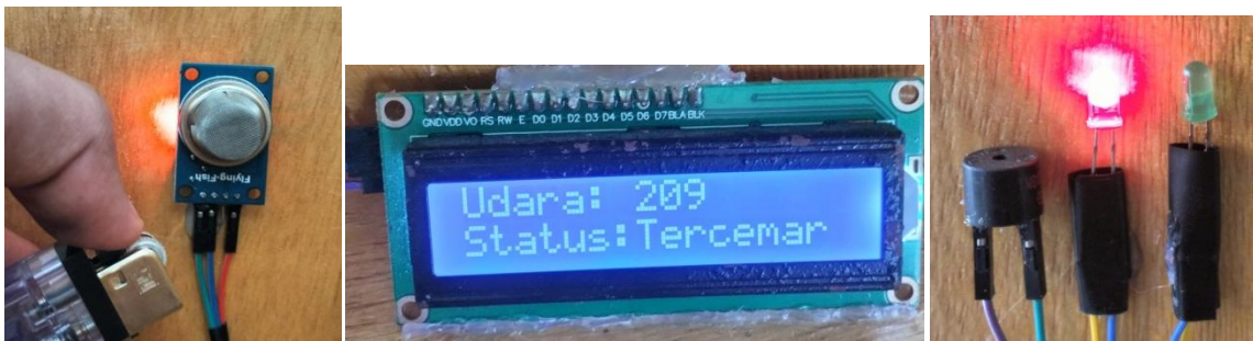
Gambar 6. Hasil Pengujian Sensor MQ-2 Kualitas Udara
