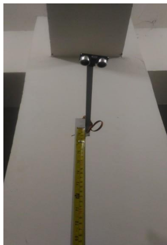
Gambar 4.8 Penempatan Sensor Ultrasonik pada Tiang Pengukur Tinggi Badan
