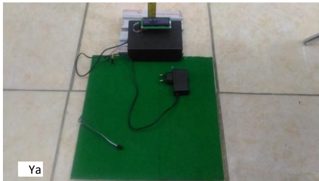
Gambar 4.7 Alas Pijakan Alat Timbangan Badan dan Layar LCD
