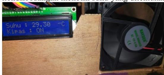
Gambar 11. Hasil Pengujian Kipas On
