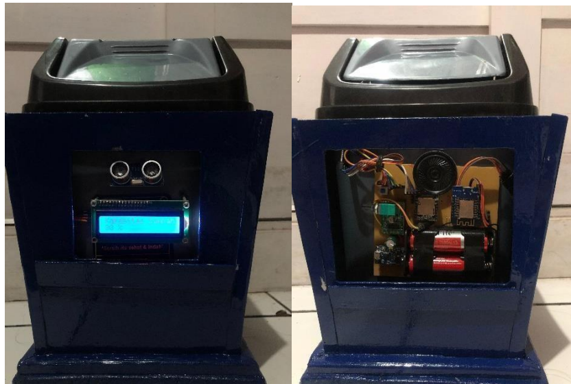
Gambar 6 Perancangan Tempat Sampah Otomatis Berbasis IoT
