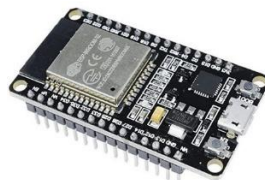
Fig. 1 NodeMCU ESP32 Type DEVKITV1
